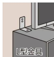
図6 対策器具の種類と効果 及び 取り付け例
