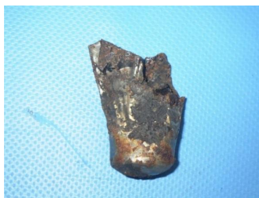
内部短絡したリチウムイオンバッテリー
