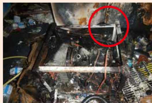
配線が原因で火災が生じた事例の写真。○の部分に配線の絡まりがあり、ここから出火しました。
