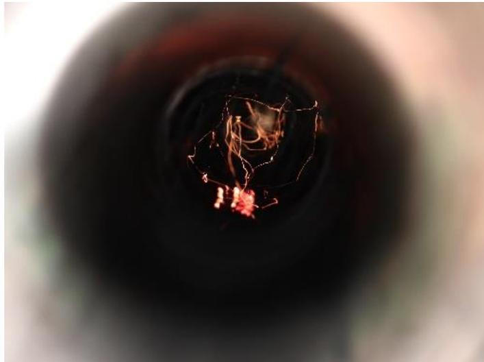
写真5-11 ダクト内部に着火した状況（着火有）
