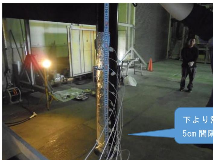
写真 5 - 5 ダクト外側の熱電対設置位置
