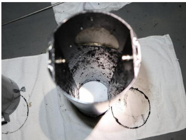
写真5-9 油塵を塗布したダクト内部の様子
