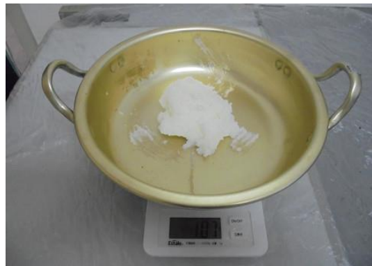
写真6-82 ダクト内塗布試料（油塵） ラード 107g
