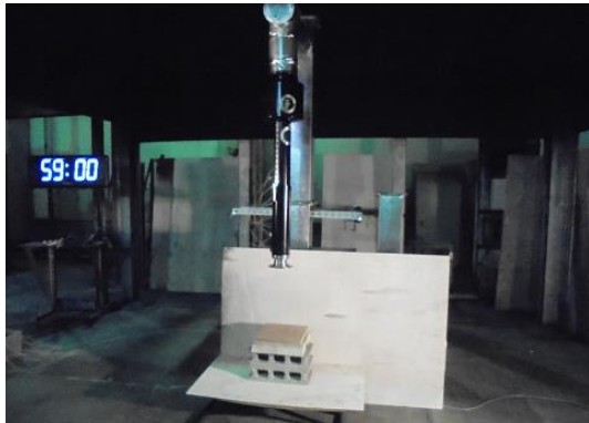
写真6-81 5m集煙フードへ 上引きダクト設置
