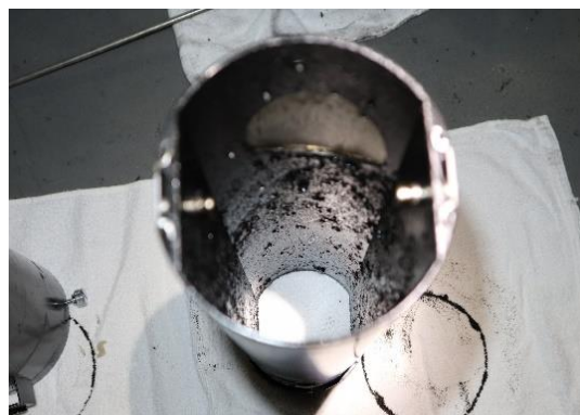
写真6-86 ダクト内へ試料（油塵） の塗布
