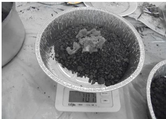
写真6-83 ダクト内塗布試料（油塵） 炭の粉末及び砕粒 106g、ほこり 1g
