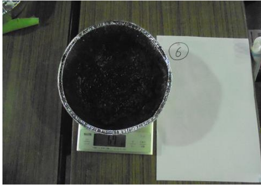
写真6-87 ダクト内へ試料塗布後 残滓 67g
