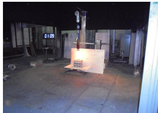
写真6-107 実験⑩ 火皿 15cm 離隔距離 40cm 風速 7m/s
