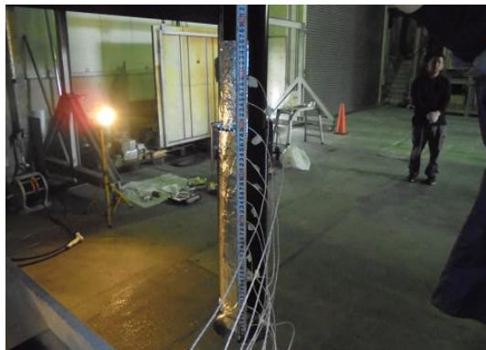
写真6-89 上引きダクト外部へ 熱電対設置
