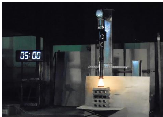
写真6-100 実験④ 火皿 15cm 離隔距離 20cm 風速 3m/s
