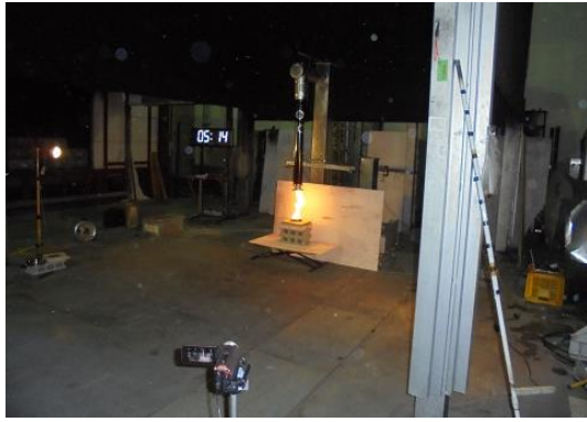
写真6-104 実験⑥ 火皿 15cm 離隔距離 40cm 風速 5m/s
