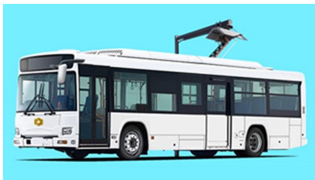
図 2-6 パンタグラフ方式による給電方法（例）
