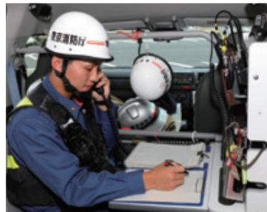
災害現場で指揮本部を設置し、情報収集や活動命令を下すために運用する車両です。ワンボックス型の車両に、無線機等の通信機や指揮台、拡声器などを搭載しています。
