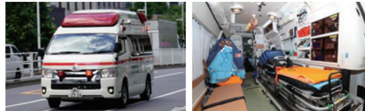
救急救命士による高度な処置が行える資器材を積載しています。車内で処置をする際、傷病者に走行時の振動を与えないよう、緩衝装置のついた防振架台を装備しています。
