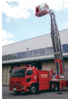
主に高所での救助、消火活動を行う車両です。30メートルと40メートルの高さまで届くものや、電線等の障害物を避けるため先端部分が屈折するはしご車があります。
