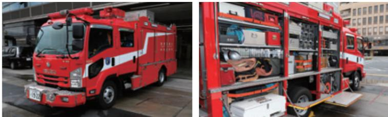
特別救助隊が災害現場で救助活動に対応するための車両です。ウインチ装置、昇降式照明装置、発電装置等を装備し、約500種類の救助資器材を積載しています。
