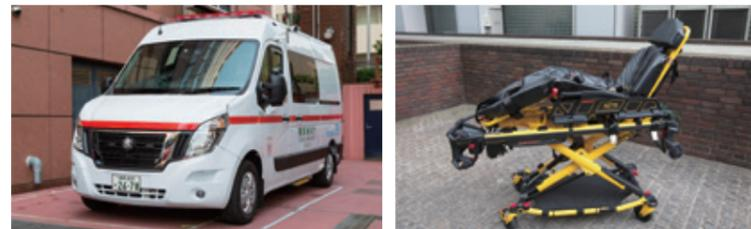
日本で初めての導入となる電気救急車です。重体重の傷病者への対応力を強化するため、電動ストレッチャー等を備えています。
