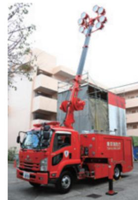
夜間の消防活動において災害現場の照明作業を行うとともに、電力を必要とする消防機器や緊急に電力供給を必要とする施設等に給電できる車両です。
