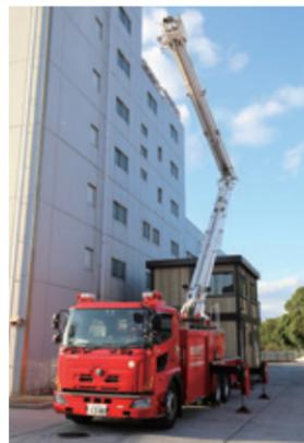
屈折2塔式放水塔を装備し、最大22メートルの高さから放水が可能な車両です。泡放射も可能なことから、高所火災、危険物火災などで絶大な威力を発揮します。
