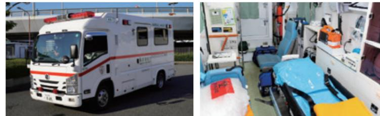
感染症の疑いのある傷病者に対応可能な車両です。運転室と傷病者の間に隔壁を設けるとともに、汚染された内部の空気を殺菌して屋外に排出できる構造とし、車内での救急処置を可能としています。
