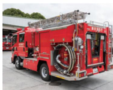
火災発生時に消火活動を行うための車両です。消火栓や防火水槽などから水をくみ上げ、毎分2,000リットル以上放水可能なポンプを搭載しています。
