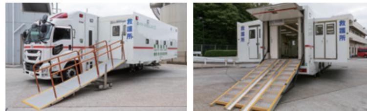
救急車として患者搬送を行えるほか、救護所としての機能を有した車両です。ボディを左右に拡張することで、最大約40平方メートルのフラットな床面になり、最大8床のベッド数を備えることができます。
