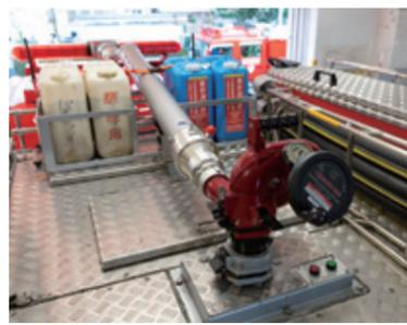
通常の放水では消火が難しいガソリンなどの危険物火災に対応するための車両です。消火に必要な泡消火薬剤や発泡器具を積載しています。
