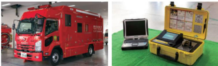
放射性物質、生物剤、危険物や毒劇物などの特殊災害に対応するための車両です。昇降式の風向風速計や車内陽圧装置(一部車両)を装備し、有毒ガスを特定する分析器、除染テント等の資器材を積載しています。
