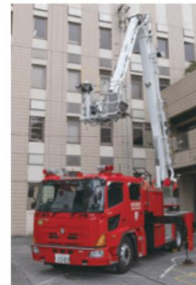
屈折式の塔の先端に3名搭乗可能なバスケットを取付けている車両です。中層階の救助、消火活動だけでなく、河川、運河等の低所での救助を行うことができます。
