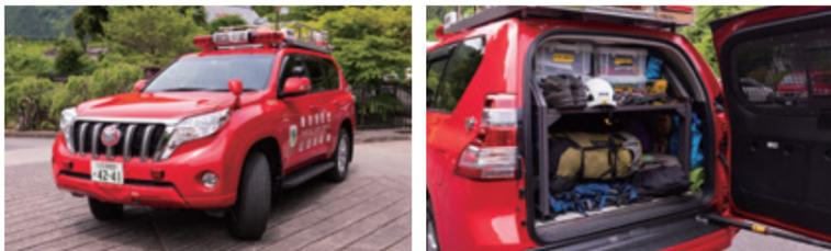
山岳救助隊が、山岳災害での救助活動を行う車両です。走破性に優れた四輪駆動車をベースに、バスケット担架等の資器材を積載可能なルーフキャリア、可動棚式資器材収納庫を装備しています。
